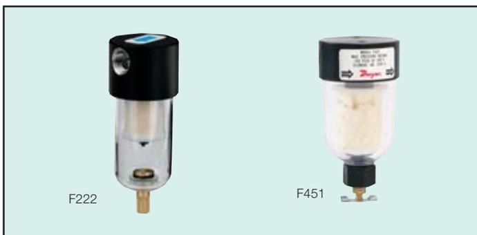
压缩空气过滤器可以保护设备和仪器不被象尘垢、水、油这样的有害污染物破坏。液体不停的经由人工排水阀进行吸入和排放。替换滤芯可除去小至 0.01 微米的微粒，且效率高达 93%。流量计的进口和出口都为 1/4" NPT 内螺纹连接，并具有人工排水阀。
