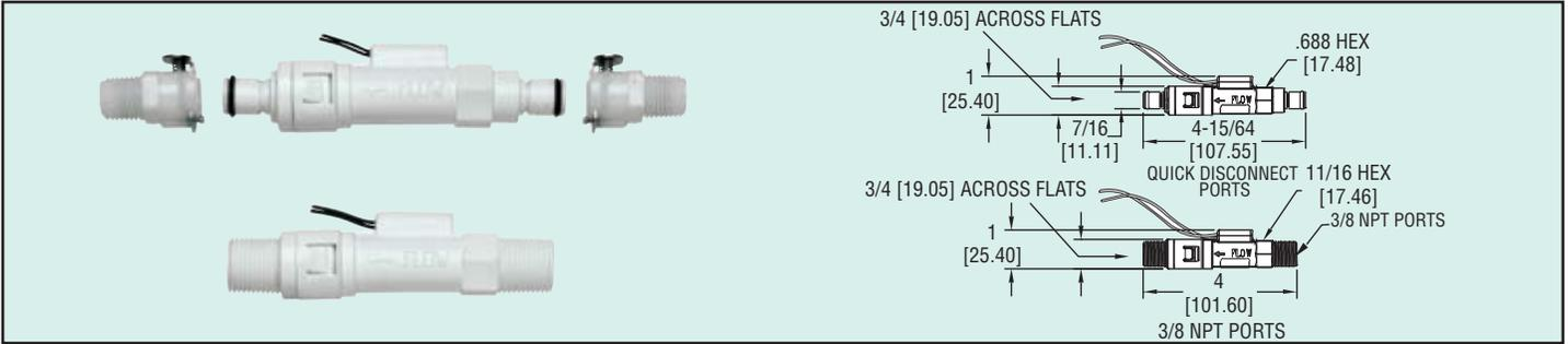
**P3** 系列聚丙烯流量开关几乎适于所有的管道要求。基本的活塞设计包括一个密封的单刀单掷常开式簧片开关。进出端口采用 3/8" NPT 外螺纹或 1/4" 快接凸接头。对直接流通液体可选用快速接头或带切断阀。从开关上取下快接接头时，切断阀可切断流量，重新安上接头后，流量会继续。由于有很多可选的快接接头，P3 流量开关可与任何已有的管道系统相连。
