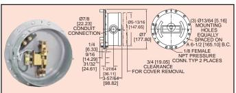
系列极敏感压力开关设计适用于空气和非腐蚀性气体的应用。大隔膜 操作的特殊磁力水银开关。工作点全部范围都可调节。有全天候防护或防 爆外壳。
